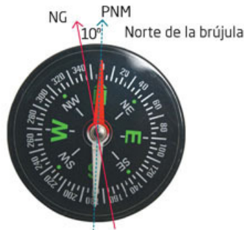
Figura 5.9 Corrección de 10° de donde apunta la brújula. Esto quiere decir que debes dirigirte 10° hacia la izquierda de donde apunta la brújula, o bien, si esta tiene un mecanismo de ajuste, mover el puntero de la aguja diez grados hacia la izquierda.
