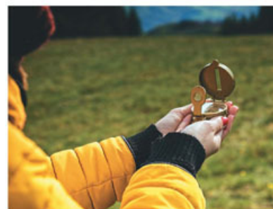
Figura 5.9 Corrección de 10° de donde apunta la brújula. Esto quiere decir que debes dirigirte 10° hacia la izquierda de donde apunta la brújula, o bien, si esta tiene un mecanismo de ajuste, mover el puntero de la aguja diez grados hacia la izquierda.
