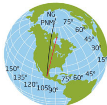
Figura 5.8 Lugar hacia donde apunta una brújula en el centro de México (línea en rojo). Observa que no apunta hacia el norte geográfico (NG) ni hacia el polo norte magnético (PNM).
