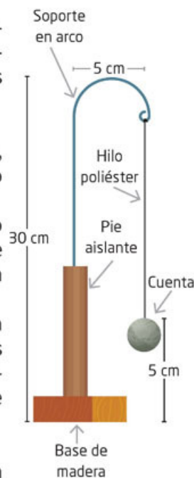
Figura 4.4 Esquema de un péndulo electrostático, similar al que se construyó en la actividad.
