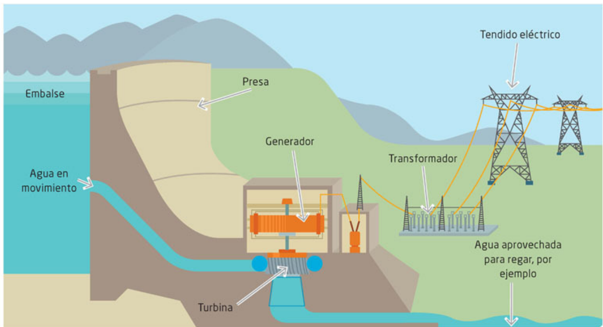
Figura 21.1 Esquema de una central hidroeléctrica.
